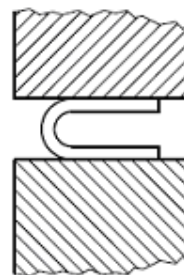
شکل ۶- شماتیک انجام آزمون خمش به صورتی که دو بازوی آزمون موازی هم قرار گیرد
